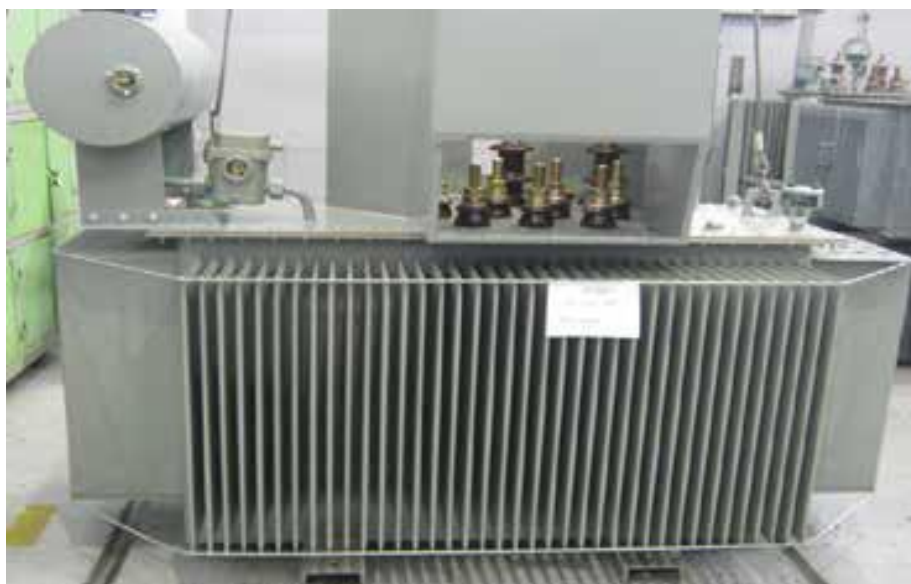
Slika br 3. Izgled transformatora 10/0,4 kV,630 kVA
