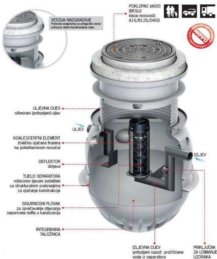
Slika 54. Izgled separatora ACO OLEOPATOR P NG10 SF1200
