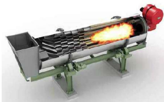
Slika 20. Presjek bubanj sušare sa gorionikom i izgled gorionika
