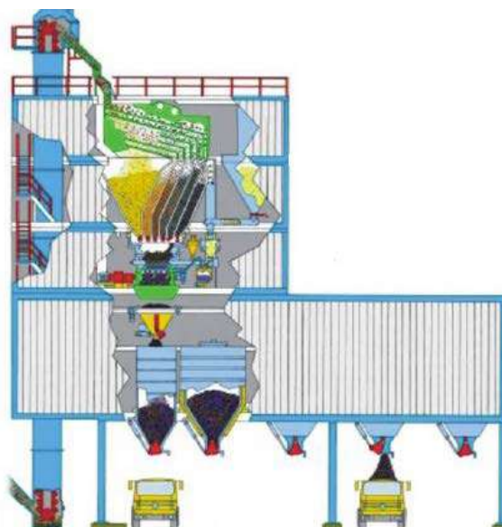
Slika 25. Izgled elevatora za doziranje agregata, filera i bitumena, miješanje mineralnih komponenti sa bitumenom i utovar gotove asfaltne mase
