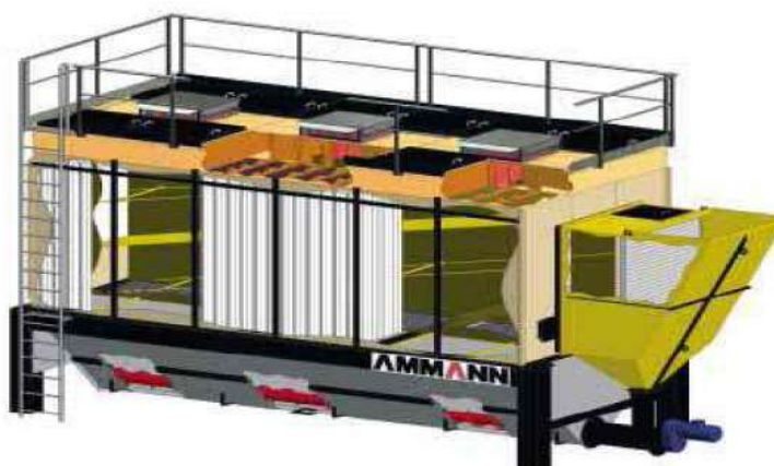
Slika 22. Presjek vrećastog filtera sa ventilatorom
